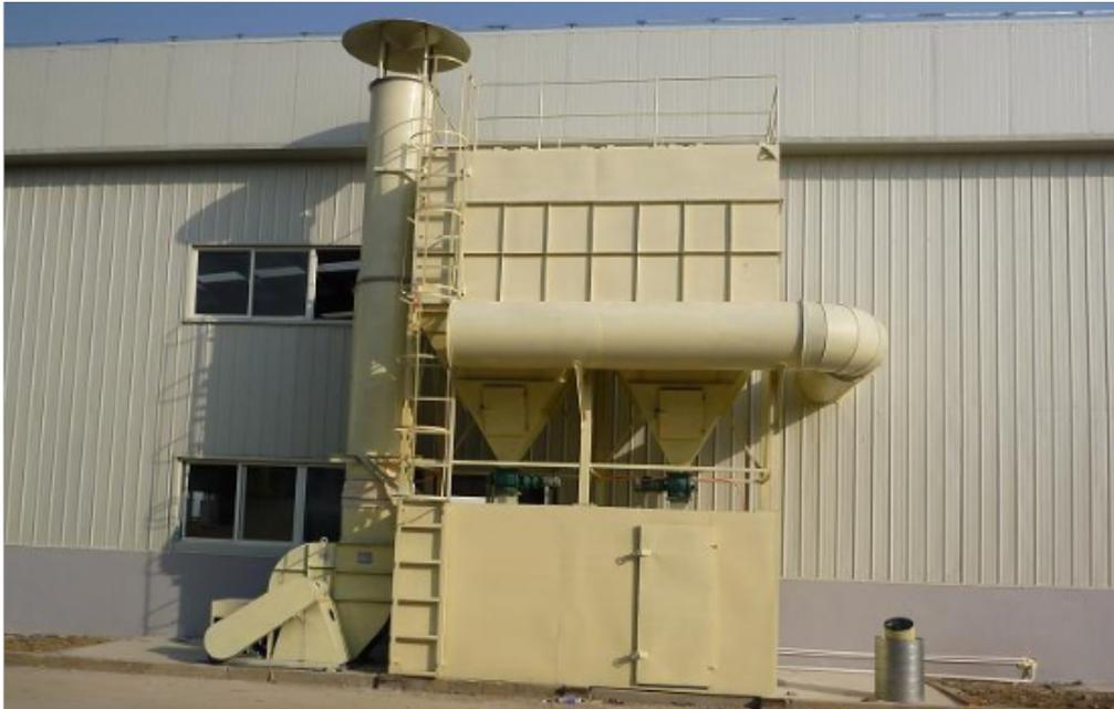
除尘器的工作好坏，不仅直接影响到除尘系统的可靠运行，还关系到生产系统的正常运行、车间厂区和周边居民的环境卫生、风机叶片的磨损和寿命，同时还涉及有经济价值物料的回收利用问题。因此，必须正确地设计、选择与使用除尘器。选择除尘器时必须多面考虑一次投资和运行费用，如除尘效率、压力损失、可靠性、一次投资、占地面积、维修管理等因素，根据烟尘的理化性质、特点和生产工艺的要求，针对性地选择除尘器。机械除尘比人工除尘方便、干净，但机械除尘费用高，现大多采用脉冲除尘法。
